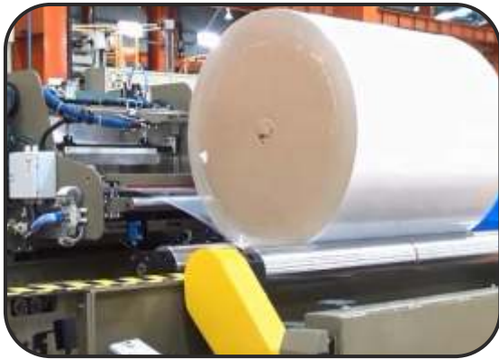
Radial Reel wrapping
